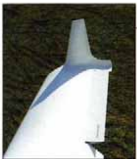
Alettone alla "ceca" Rispetto all'apertura dei flap, gli alettoni di questo Ulm hanno dimensioni molto ridotte. A fianco, una vista dall'alto evidenzia la decisa rastremazione di ala e fusoliera, nonché l'ingombro del grande vano motore.
