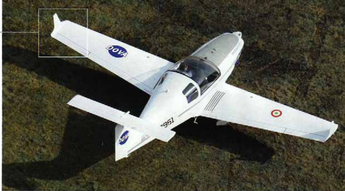
Alettone alla "ceca" Rispetto all'apertura dei flap, gli alettoni di questo Ulm hanno dimensioni molto ridotte. A fianco, una vista dall'alto evidenzia la decisa rastremazione di ala e fusoliera, nonché l'ingombro del grande vano motore.
